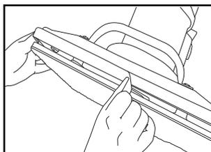
3.-Retire el papel de la tira de velcro exponiendo el adhesivo, y pegue el velcro en la orilla de la base alrededor de la máquina. Asegurese de apretar firmemente el velcro para mejorar la adherencia.
