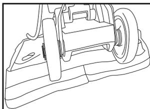
4.-Asegurese que el velcro quede en la parte de arriba de la falda y que los extremos de la falda queden unidos en la parte posterior de la máquina.
