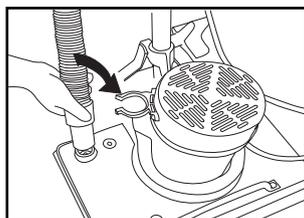
6.-Conecte la manguera al cople de la máquina y a la abrazadera de la manguera. Es posible conectar una manguera de 1 1/2" ó 1 3/4" de diámetro.
