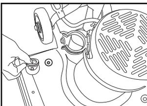
5.-Instale la abrazadera de la manguera en la cubierta del motor. Utilice los 2 tornillos incluidos en el kit y retire la tapa del cople.
