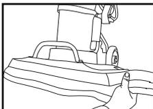
**Instale la falda, uniendo el velcro de la falda y el instalado en el chasis.**
